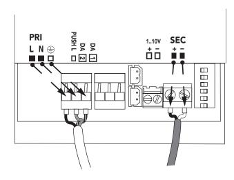
Schieben Sie über die Zuleitung des Deckenauslass den beiliegenden weißen Glasseidenschlauch zur Isolierung. Dieser muss bis in den Anschlussraum des Betriebsgerätes reichen. (Kürzen Sie diesen bei Bedarf)
