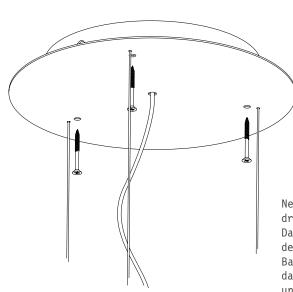
Nehmen Sie den Baldachin zur Hand, sowie drei passende Schrauben.
