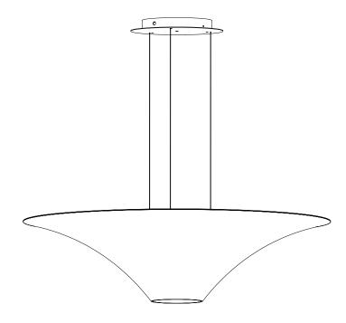
Für ein direktes Licht nach unten, richten Sie den LichterTrichter waagerecht aus. Falls Sie das direkte Licht an anderer Stelle brauchen, können Sie den LichterTrichter ganz einfach in fast jede Richtung ausrichten, indem Sie die Länge der Drahtseile dementsprechend anpassen. Die Drahtseilhalter sind drehbar gelagert. Achten Sie darauf, dass die Gelenke Drahtseilhalter in Zugrichtung belastet werden.
